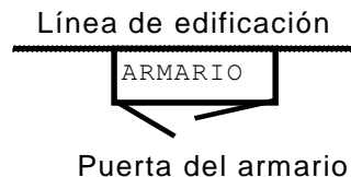
Fig. 3 - Subrepartidor sobre línea de edificación
